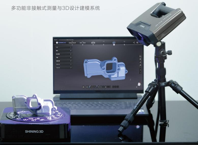
EinScan Pro EP多功能非接触式测量与3D设计建模系统,通过不同的模块与扫描模式配合,可满足不同尺寸实物的多重细节和精度要求的3D数据采集与设计需求,适应广泛的3D测量与设计应用场景,是快速获取高品质3D模型的理想选择,是全球多个CAD机械设计赛项指定设备。
