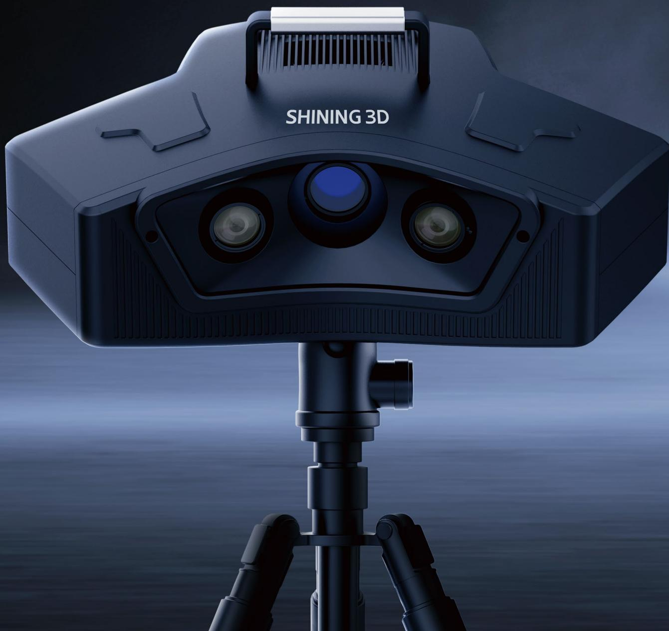
OptimScan 13M计量级高精度蓝光三维扫描仪，延续采用窄带蓝光光源，抗干扰性强，配合功能强大的三维重建算法，实现了计量级别的测量精度，精度可达4微米。其搭载1300万像素高性能工业相机，可获取物体表面高精细几何特征。同时，设备采用模块化镜头设置，可以实现不同测量范围快速切换，以适应多种高精度3D测量需求。
