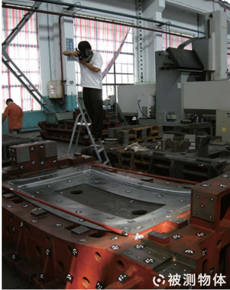
1. 在被检测处贴好标志点，并在检测范围内布置编码点和标尺，使用高分辨率相机多角度拍摄
