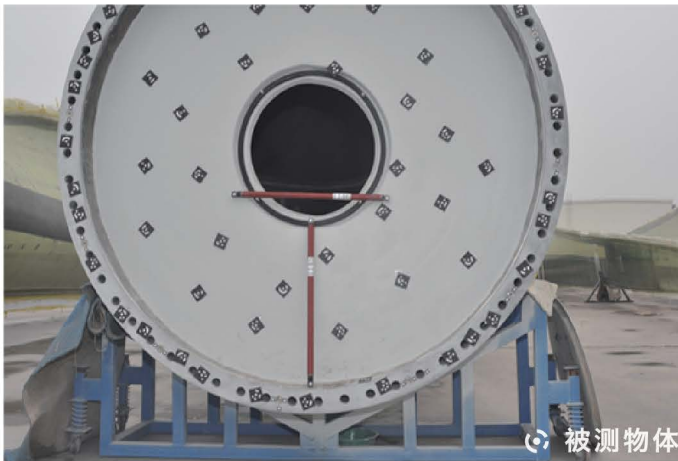
1. 在需要检测处贴标志点，在检测范围内布置编码点和标尺，使用高分辨率相机在不同角度进行拍摄
